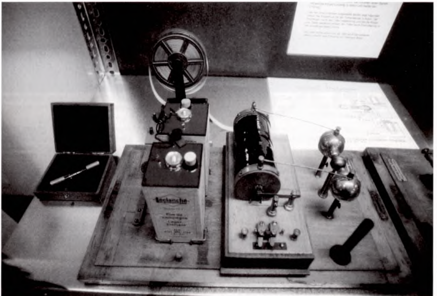
Um 1900 sah ein handelsüblicher Funkensender nach dem Prinzip von Hertz so aus. Ausstellungstück im Rundfunkmuseum Fürth. Foto: A. Mayer
