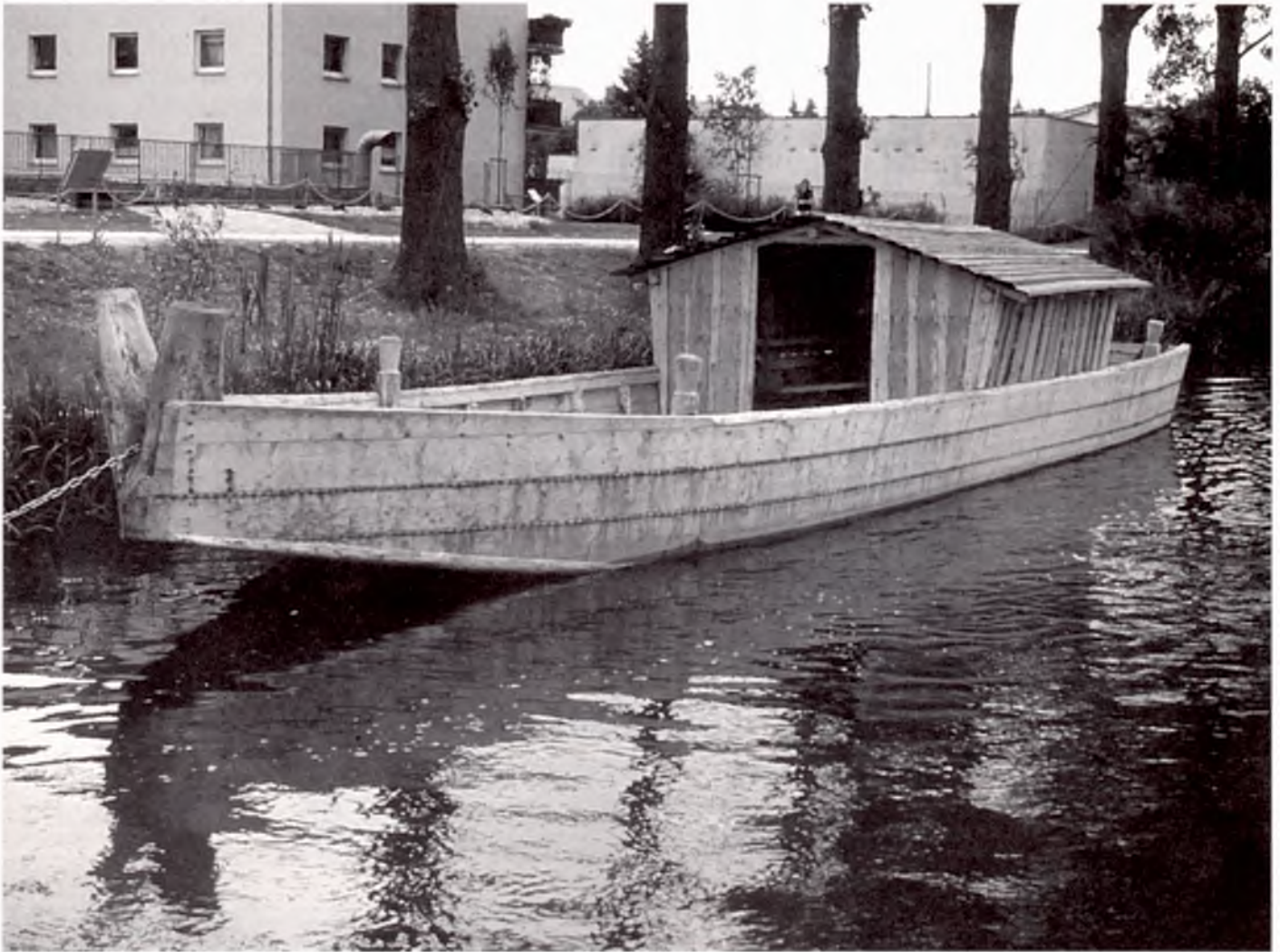
Der Treidelkahn - ein Hauptverkehrsmittel in karolingischer Zeit. Das Bild zeigt den Nachbau eines Kahns aus dem 19. Jh. Es wurden keine Nägel und Schrauben verwendet, nur Holzverbindungen. Vor 1000 Jahren sah so ein Kahn wohl kaum anders aus. Foto: A. Mayer.
