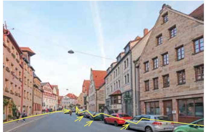
Während links noch eine Baulinie erkennbar ist, sind rechts die Häuser in der Königstraße um 2–3 Meter zurückversetzt
