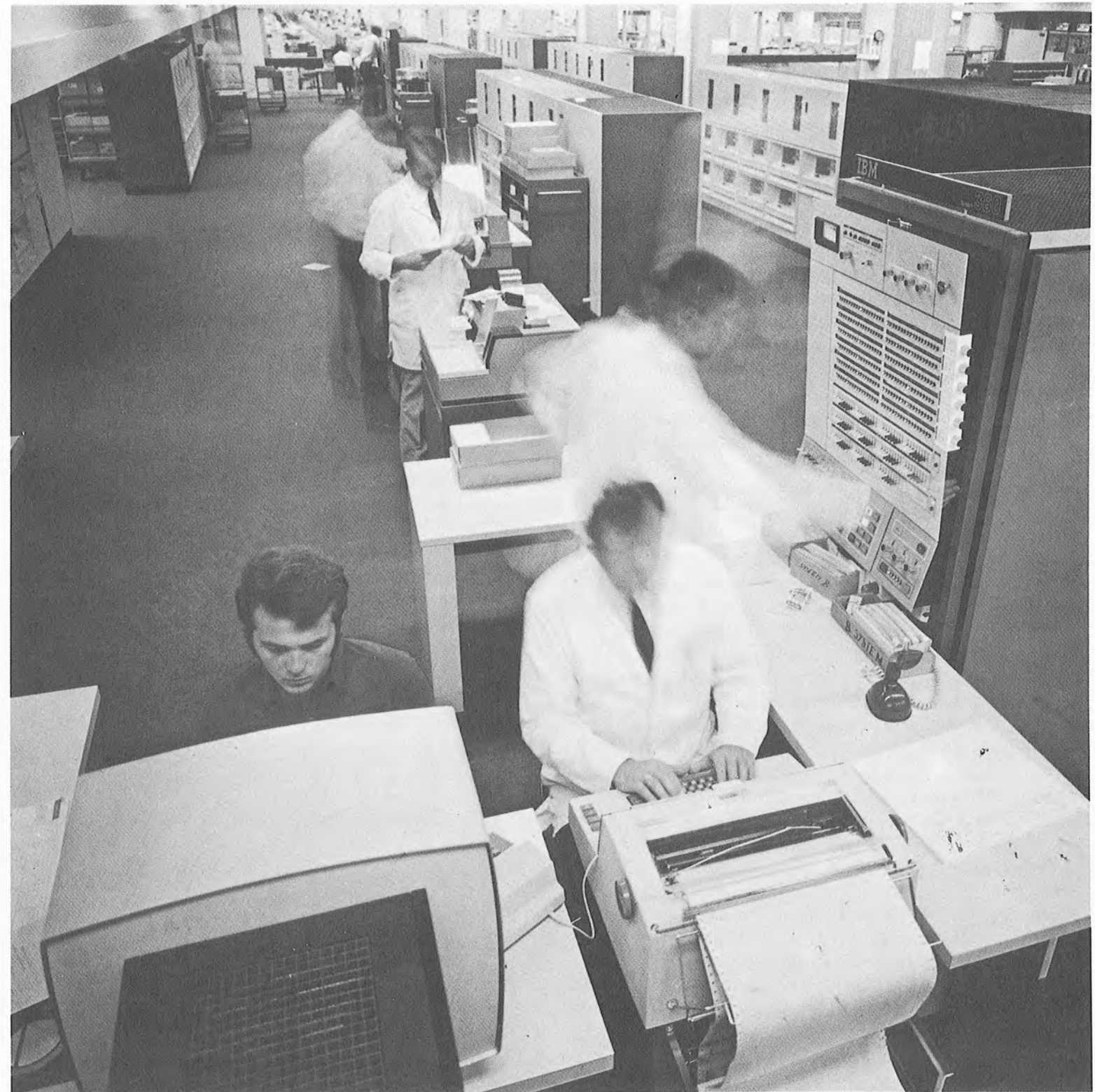
Datenverarbeitung heute: Steuerpult des Computers IBM/360-65
